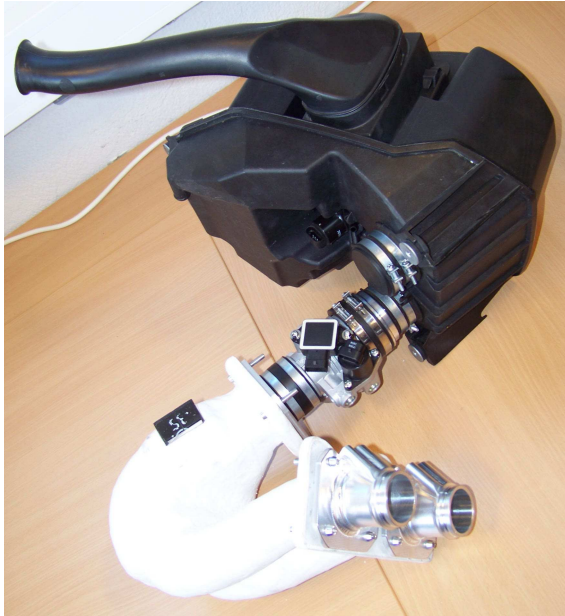
Abbildung 1-3: Prototyp des Zweivolumenansaugtraktes für den Zweizylindermotor
