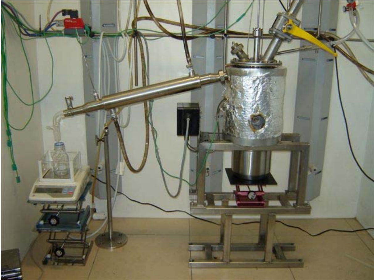
Abbildung 91: Versuchsaufbau zur Bestimmung der flüssigen Produkte
