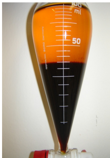
Abbildung 50: Wässrige Produkte (untere schwarze Phase WPH) und Trägerölphase (obere braune Phase) der Flüssigphasenpyrolyse
