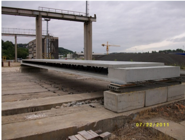
Abbildung 4: Fertigteildecke, Großversuch Gera
