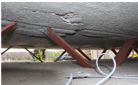
Abbildung 7: Versagenspunkte des Versuches in Gera
