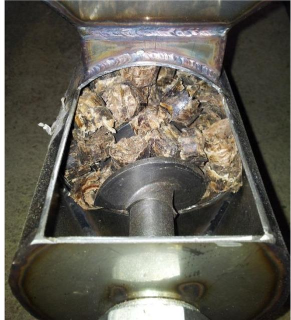
*Abbildung 5-8: zerkleinerte Pellets in Fördersystem*
