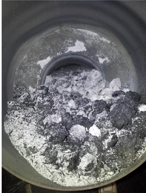
**Abbildung 6-28: Reaktorinhalt nach Streuwiesengras 80/20 mit Additiv-I**
