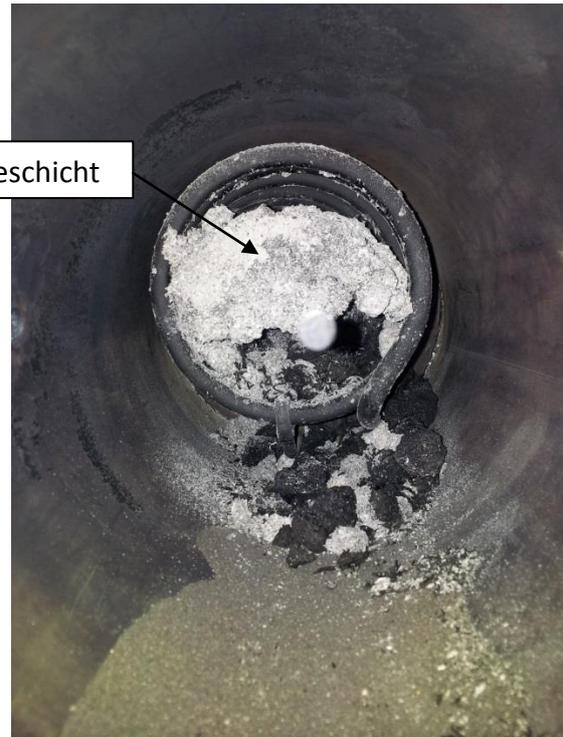
**Abbildung 6-21: Ascheklumpen in Heizwendel der Freiboardheizung**
