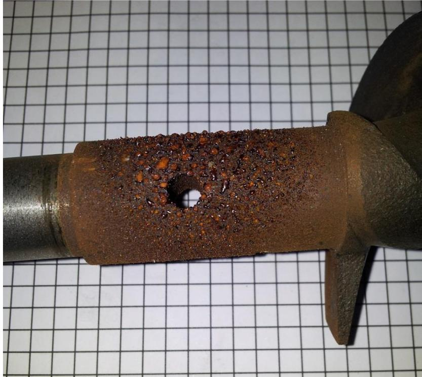
**Abbildung 6-38: Korrosion nach EBS 80/20**
