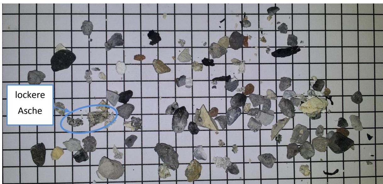
**Abbildung 6-16: Aus Bettmaterial ausgesiebte Rückstände auf 5x5mm Raster von Kronenrestholz 80/20-III**
