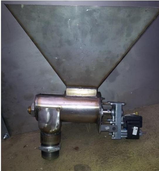
**Abbildung 5-5: Brennstofffördersystem**
