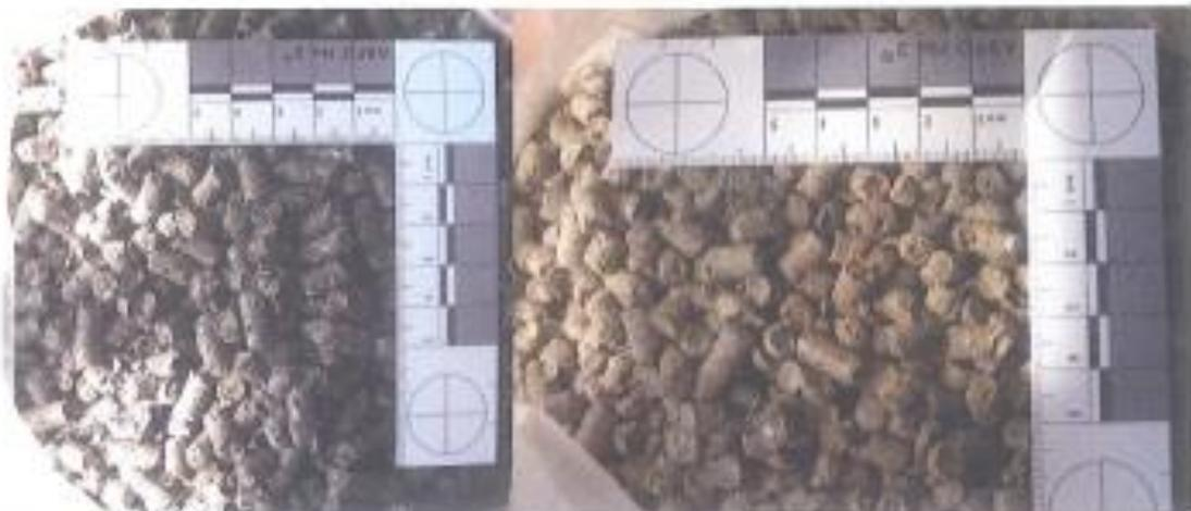
Abbildung 1 und 2: Nr.: 408.236-1 „Pellets 50% EBS 50% HHS“ (links); Nr.: 408.236-2 „Pellets 20% EBS 80% HHS“ (rechts) bei Anlieferung
