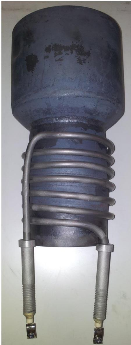
**Abbildung 5-2: Wirbelschichtreaktor mit Heizung**
