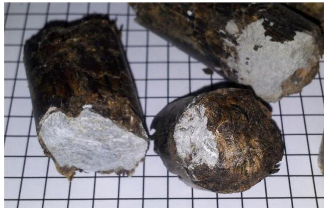
**Abbildung 6-9: Steine in Pellets; hier exemplarisch in Kronenrestholz 80/20-Pellets auf 5x5mm Raster**
