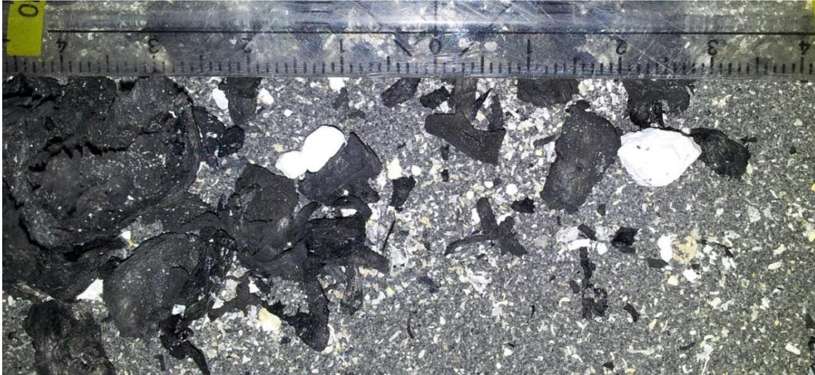
**Abbildung 6-8: Auszug aus Bettmaterial nach Versuch: Koks, Steine (weiße Klumpen), Sand und Asche**
