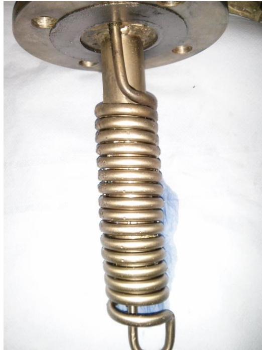
Abbildung 6-7: Innenseite des Kondensators nach 300 Betriebsstunden
