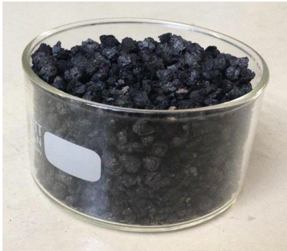
Abbildung 6-32: Gesamter Koksinhalt bei allothermer Betriebsweise: 180 ml Koks
