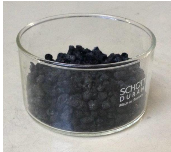
Abbildung 6-33: Gesamter Koksinhalt bei autothermer Betriebsweise: 80 ml Koks
