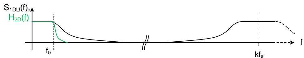
(f) Unterdrückung von Aliasing im Nutzband S_{1DU}(f) durch Überabtastung k \cdot f_s
