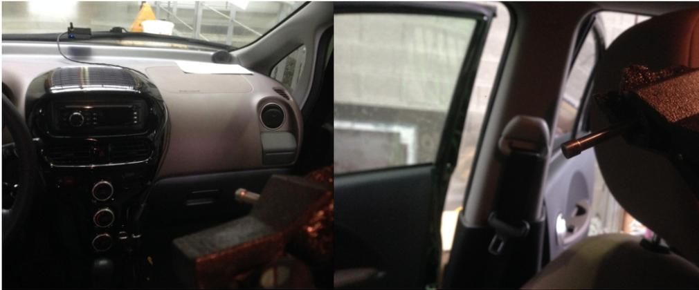
Abbildung 6.13: Messmikrofon auf Stativ auf Ohrhöhe des Fahrers
