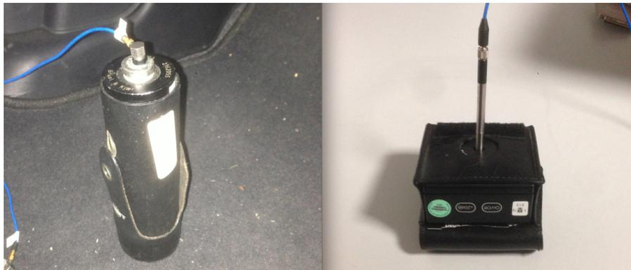
Abbildung 6.8: Links: Beschleunigungskalibrator und Sensor - Rechts: Akustischer Kalibrator und Mikrofon
