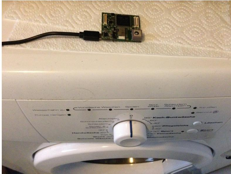
Abbildung 6.1: Waschmaschine Whirlpool AWO 5346 mit VIFDAQ Messsystem - Beschleunigungsmessung in x-Richtung (im Bild von rechts nach links)
