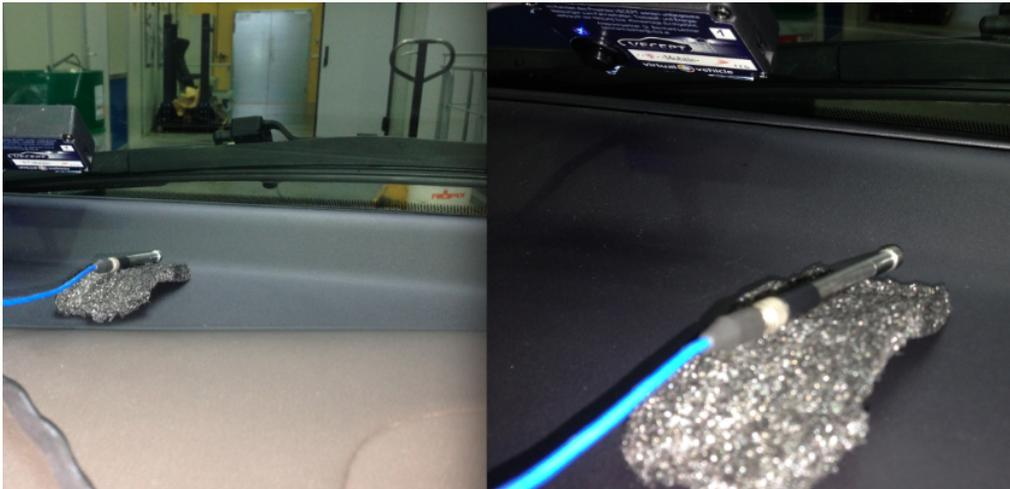
Abbildung 6.14: Messmikrofon gelagert auf akustischen Schaumstoff am Armaturenbrett vor dem Lüfter
