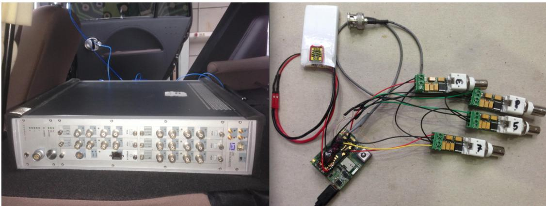
Abbildung 6.6: Links: Referenzmesssystem LMS SCADAS 305 - Rechts: Versuchsaufbau des Messsystem ViFDAQ mit Lithium-Ionen Akkumulator und externen analogen IEPE Eingangsträgern ICP\_FM1
