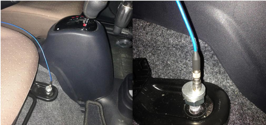
Abbildung 6.22: Beschleunigungssensor geschraubt auf die Stellschiene des Beifahrersitzes; Messung in z-Richtung
