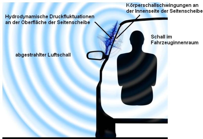
Abbildung 1.4: Schematische Darstellung der Schalldrücke die im Windkanal gemessen wurden. [MAGNA STEYR Fahrzeugtechnik]
