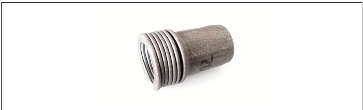
Abbildung 67: Stauchrohr aus Stahl nach einem Versuch
