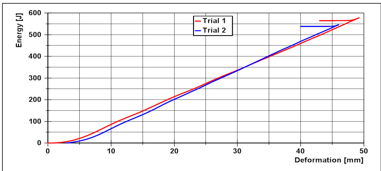
Abbildung 85: In die Aluminiumwaben eingebrachte Energien bei den Inbetriebnahmeversuchen
