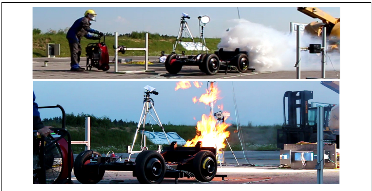
Abbildung 105: Reaktionen des elektrischen Energiespeichers nach Versuch 3
