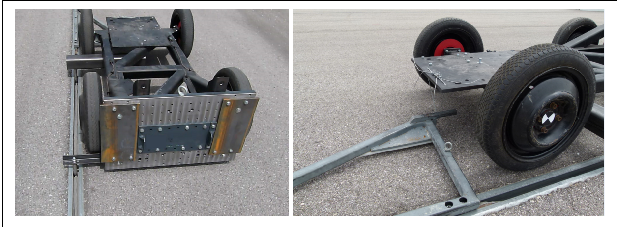
Abbildung 97: Führung und Antrieb des Stoßwagens am Freilufttestgelände
