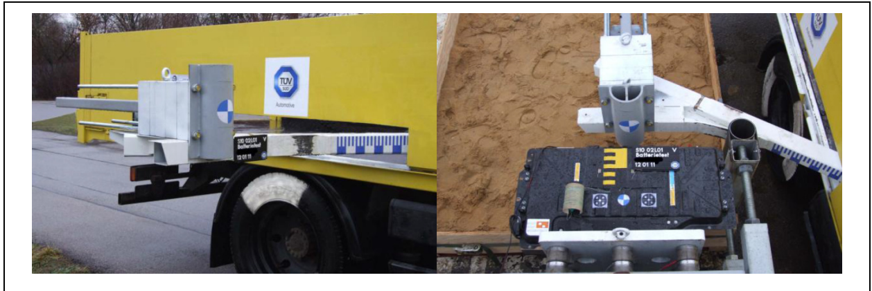
Abbildung 7: Batterie tests des TÜV Süd mit bewegtem Impaktor [18]
