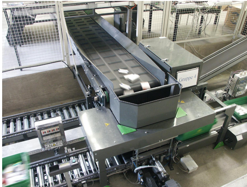
Abbildung 21: Übergabestation von ZB in Auftragsbehälter 58
