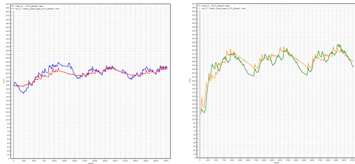
Abbildung 4-59: Vergleich der Temperatur nach SCR zwischen Messung und Simulation im Stadtbetrieb (links - Messung = blau, Simulation = rot) und im Überlandbetrieb (rechts - Messung = blau, Simulation = rot)
