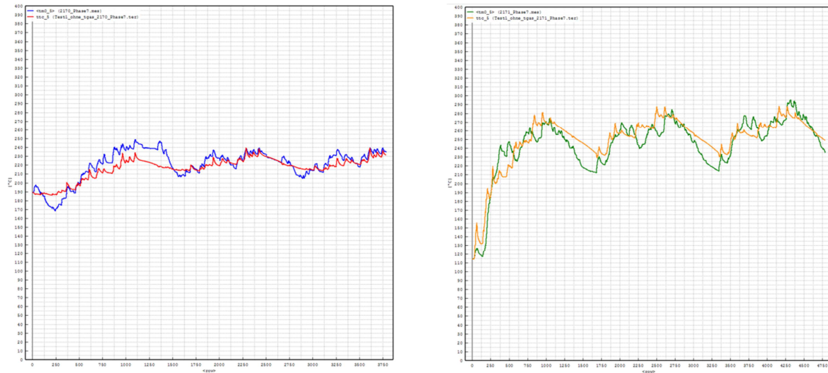
Abbildung 4-61: Vergleich der Temperatur nach SCR zwischen Messung und Simulation im Stadtbetrieb (links - Messung = blau, Simulation = rot) und im Überlandbetrieb (rechts - Messung = blau, Simulation = rot)
