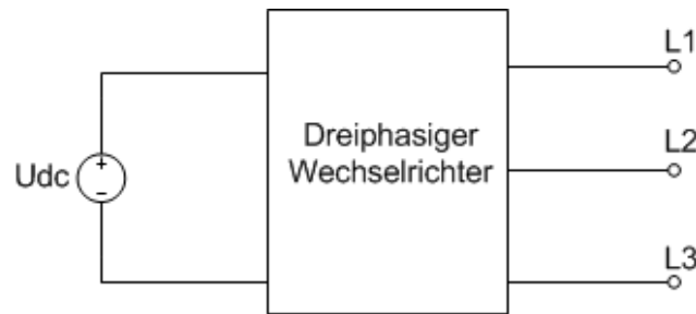
Abbildung 2-6; Schematisches Diagramm des dreiphasigen Vollbrückenwechselrichters
