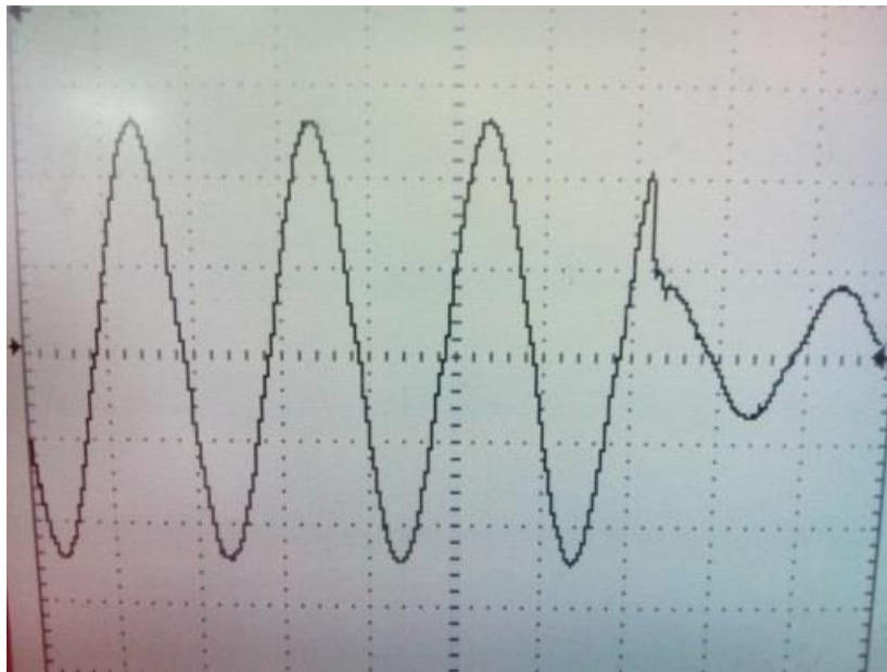
Abbildung 5-14; Spannungseinbruch bei einem einphasigen Erdkurzschluss
