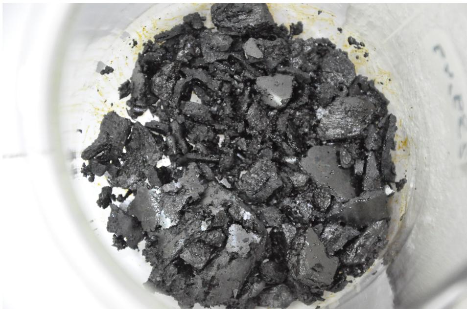
Abbildung 4.35: Festes Produkt bei der PCL ohne Trägermedium
