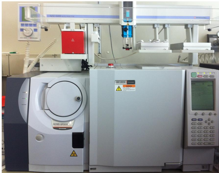
Abbildung 9: GC-MS Aufbau [126]
