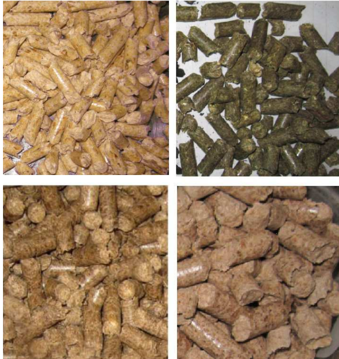
Abbildung 45: Verwendete Biobrennstoffe. Links oben: Normholzpellets Fichte. Links unten: Miscanthuspellets. Rechts oben: Heupellets. Rechts unten: Strohpellets
