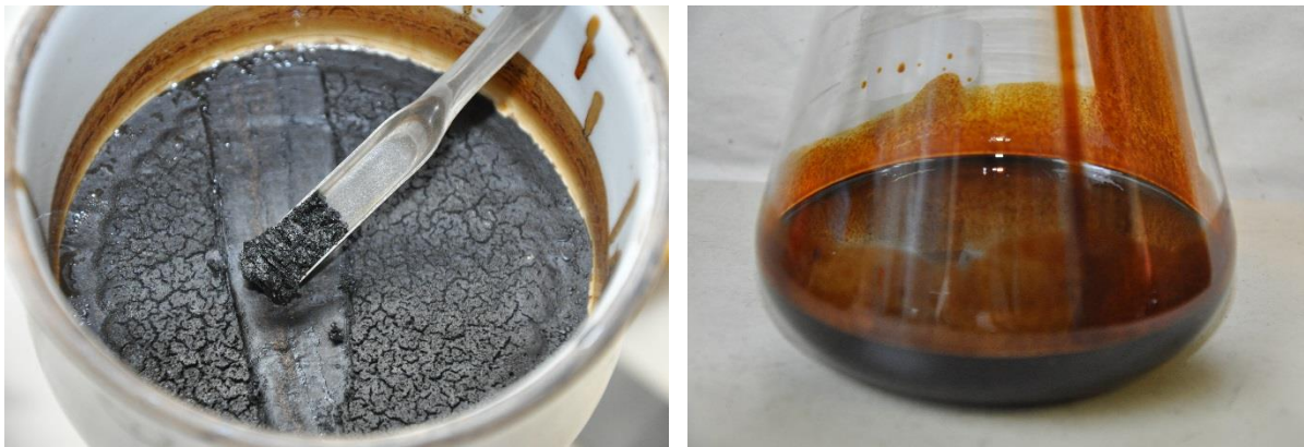
Abbildung 26: Kohlerückstand ( K_{\text{AUS}} ) (links), flüssige Produktphase (rechts)
