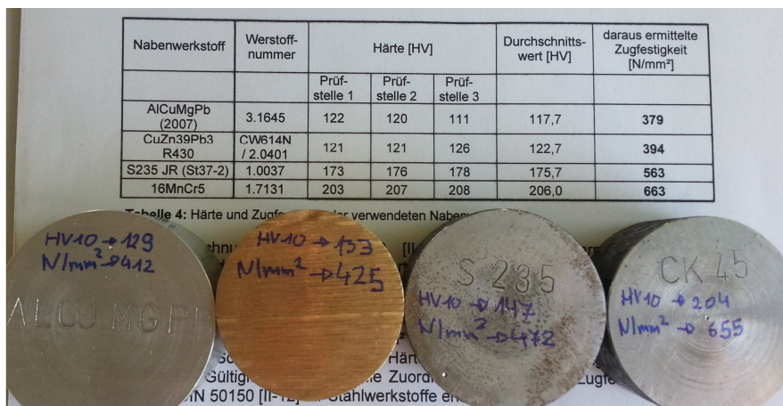
Abbildung 5.6: Vergleich der Festigkeitskennwerte mit Literatur [19]
