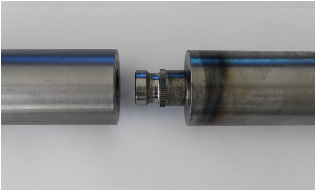
Abbildung 2.4: Selbstschneidende Rändel- WN- Verbindung
