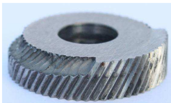
Abbildung 3.9: Bruch des Rändelrades bzw. Rändelfräasers [8]
