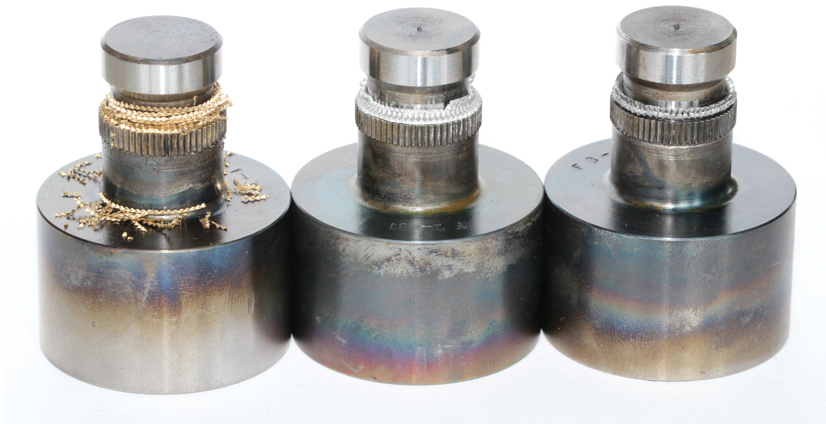
Abbildung 5.24: Spanarten der untersuchten Werkstoffkombinationen bei -10^\circ Spanwinkel
