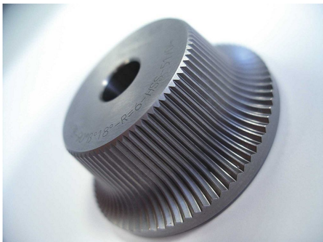
Abbildung 1.16: Spezialrändelräder zur Herstellung von Sonderrändelungen [12]
