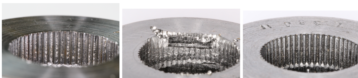
Abbildung 5.33: Unterschiedliche Verzahnungsqualität der untersuchten Stahl-Naben bei verschiedenen Spanwinkel (v.l. -10^\circ , +45^\circ und +60^\circ )
