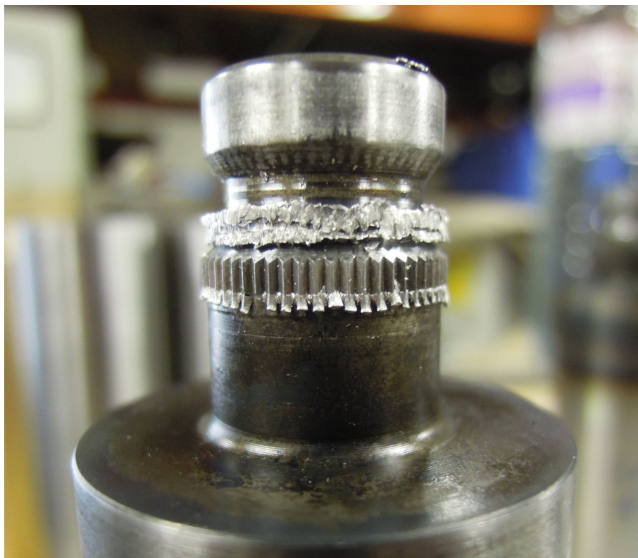
Abbildung 5.31: Spanbildung im Lösevorgang an der Rändelhinterkante
