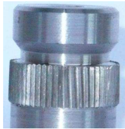
Abbildung 3.6: Überschneiden der Rändelverzahnung [8]
