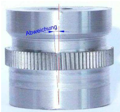
Abbildung 3.5: Rändelverzahnung nicht achsparallel [8]
