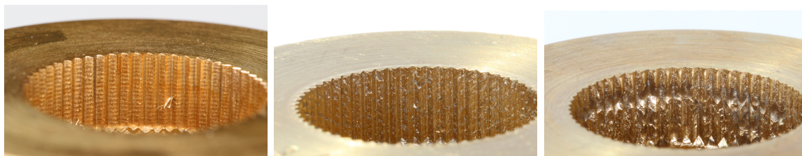
Abbildung 5.32: Unterschiedliche Verzahnungsqualität der untersuchten Messing-Naben bei verschiedenen Spanwinkel (v.l. -10^\circ , +45^\circ und +60^\circ )
