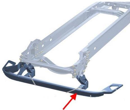
Abbildung 3.8: Ungünstiger Lastpfad im Crash-Fall über massiven Knotenpunkt
