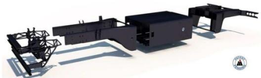
Abbildung 2.1: Nutzfahrzeug Leichtbaurahmen [3]
