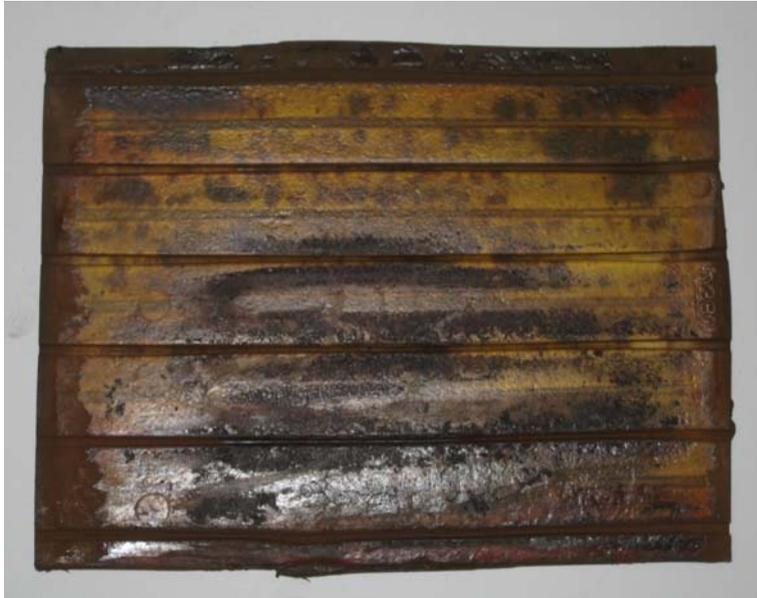
Betonschwelle „16“ wurde daher mehr Wert auf den Verschleiß und weniger auf die Elastizität gelegt, die Zwischenlagen wurden aus Polyethylen hergestellt. Die Formgebung der Gummizwischenlagen wurde beibehalten, es finden sich bei der Kunststoffzwischenlage mit der Regelzeichnungsnummer 16971/1 (Abb. 1.73) wieder dieselben Längsriefen.
