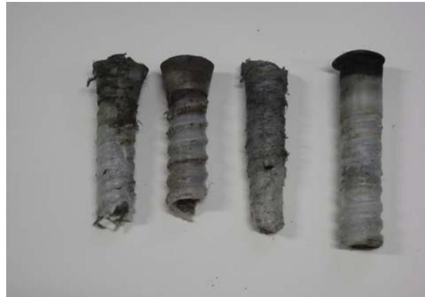
Abb. 1.83: Vor allem in Bogengleisen mit fortgeschrittenem Zwischenlagenverschleiß traten immer wieder Zerstörungen der HDPE-Dübel auf. Dies war der Grund, warum die ÖBB mit einigen Partnern im Jahr 2001 begannen den neuen Dübel (Sdü 25) zu entwickeln.
