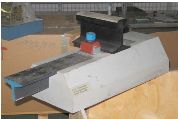
Abb. 1.31: Die Rippenplatte ist bei der Zweiblockbetonschwelle „22“ auf aus Altschienen hergestellten T-Trägern aufgeschweißt. Die Konstruktion hat sich auch in Bögen bewährt. (Foto: TMW)
