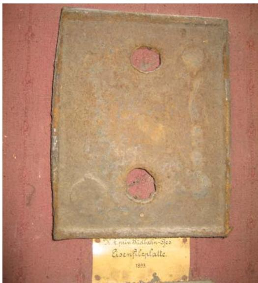
Im Archiv des Technischen Museums in Wien finden sich Unterlagsplatten aus verschiedensten Materialien, z.B. eine Baugewebeplatte oder auch eine Unterlagsplatte aus Eisenfilz (Stahlwolle). Die Eisenfilzplatte (Abb. 1.12) wurde 1893 auf der K. k. priv. Südbahn eingesetzt. Dies zeigt, dass die sonst üblichen Weichholzplatten nicht überall ein ausreichendes Verschleißverhalten, dies gilt wahrscheinlich auch hier vor allem für Bogengleise, erreicht haben.
