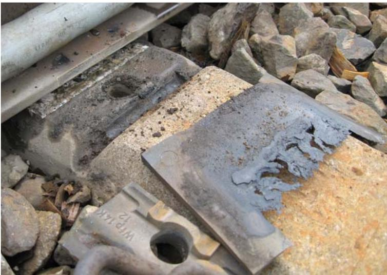
Abb. 1.76: In Bogengleisen ist es wichtig, den richtigen Zeitpunkt zum Tausch der Zwischenlagen nicht zu verpassen. Der fortschreitende, einseitige Zwischenlagenverschleiß führt ab einer bestimmten Schädigungstiefe zu Zerstörungen des Schienenauflegers im Bereich der Betonschwelle.
