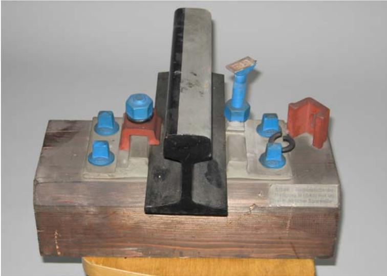
Abb. 1.13: Rippenplattenbefestigung B (S 49) (Foto: TMW)
