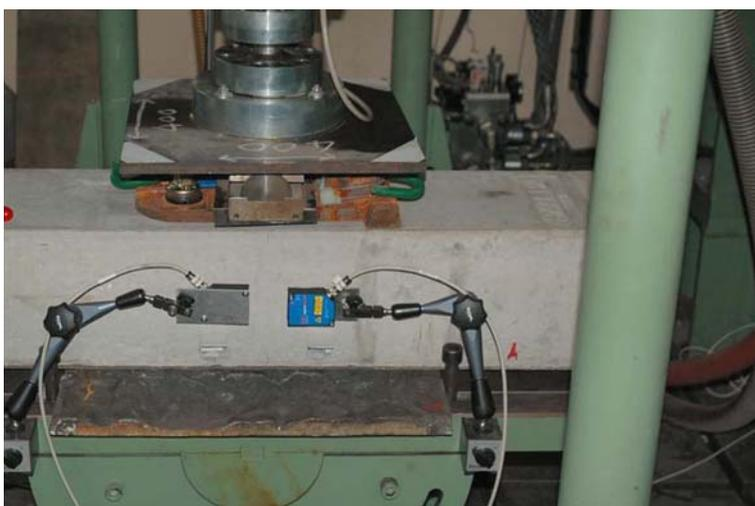
Abb. 1.52: Der statische und dynamische Bettungsmodul von Schwellenbesohlungen werden mit der sogenannten Normschotterplatte bestimmt. Weiche Schwellenbesohlungstypen weisen einen statischen Bettungsmodul von  $0,10 \text{ N/mm}^3$ , steife Varianten einen statischen Bettungsmodul von  $0,30 \text{ N/mm}^3$  auf. [12]
