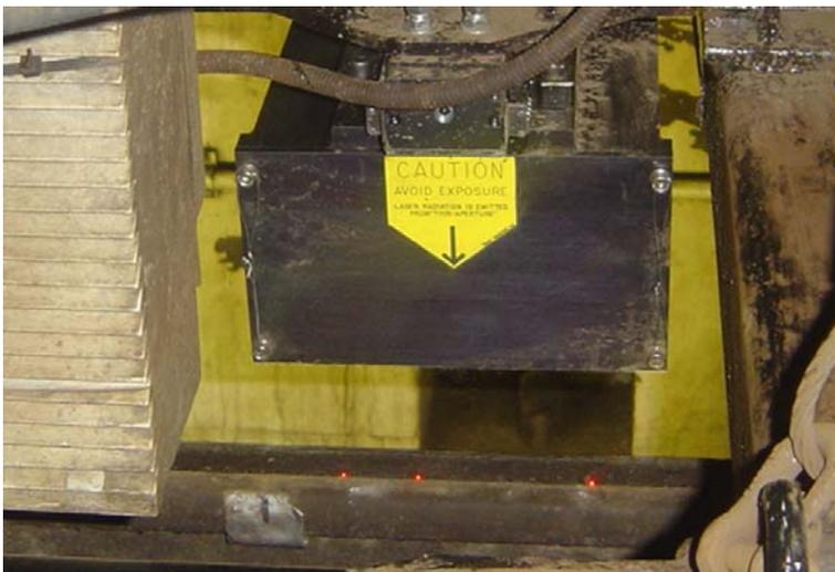
Die Schienenoberfläche wird damit in Längsrichtung alle 5 mm abgetastet. Der Messung liegt eine Laser-Distanz-Sehnenmessung mit asymmetrischer Abtastung zugrunde (Abb. 2.63).
