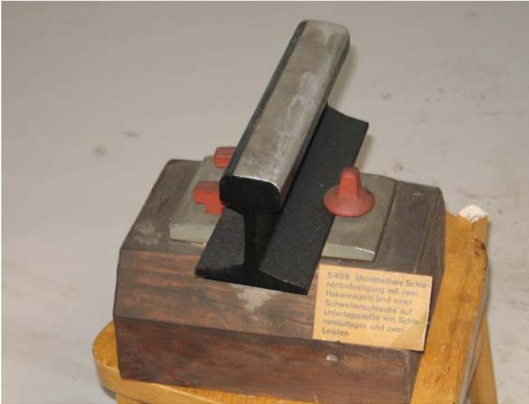
*Abb. 1.10: Unmittelbare Schienenbefestigung mit zwei Hakennägeln (Schienenaußenseite) und einer Schwellenschraube (Fahrkantenseite) auf Unterlagsplatte mit geneigtem Schienenauflager und zwei Leisten*
