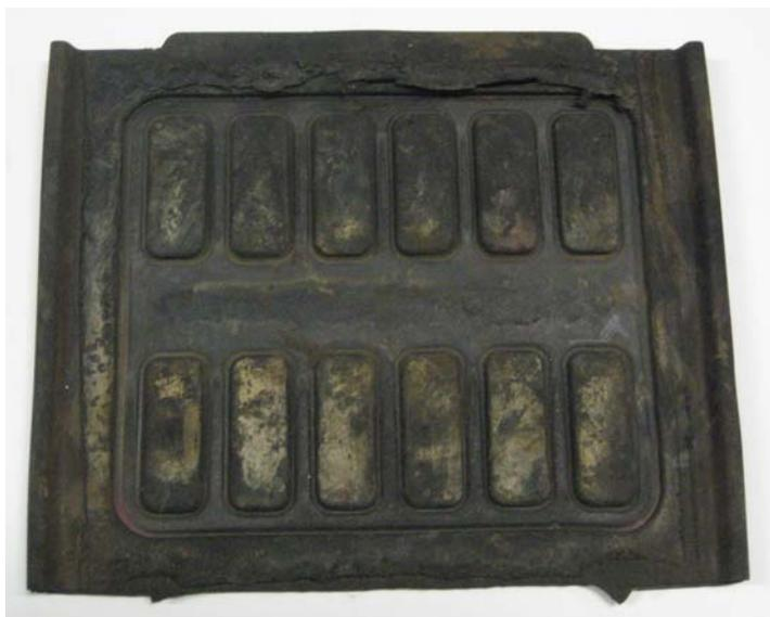
(dynamische zu statische Steifigkeit) definieren. Zwischenlagen der Klasse I weisen eine Versteifung kleiner als 1,5 auf und werden im Hochgeschwindigkeitsbereich eingesetzt. Zwischenlagen der Klasse II dürfen dynamisch stärker versteifen.
