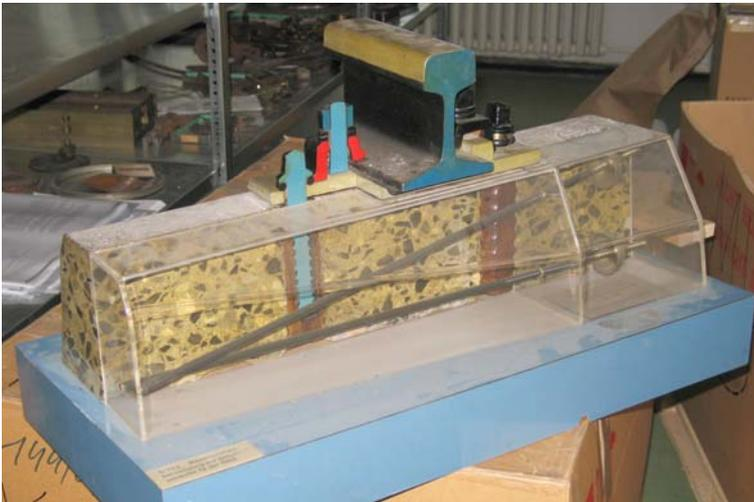
Abb. 1.61: Nach den positiven Erfahrungen mit der Rippenplattenbefestigung mit Klemmplatte, dem sogenannten K-Oberbau wurden die ersten Betonschwellen ebenfalls mit dieser Befestigung ausgestattet. (Foto: TMW)
