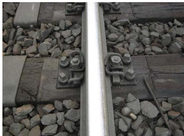
Abb. 1.18: Abhilfe gegen das gleismittige „Durchfallen“ der Skl-12-Federarmenden schafft der Einsatz der Skl 3 bzw. Skl 24 (längere Federarme) bzw. der Einsatz einer Klemmplatte.
