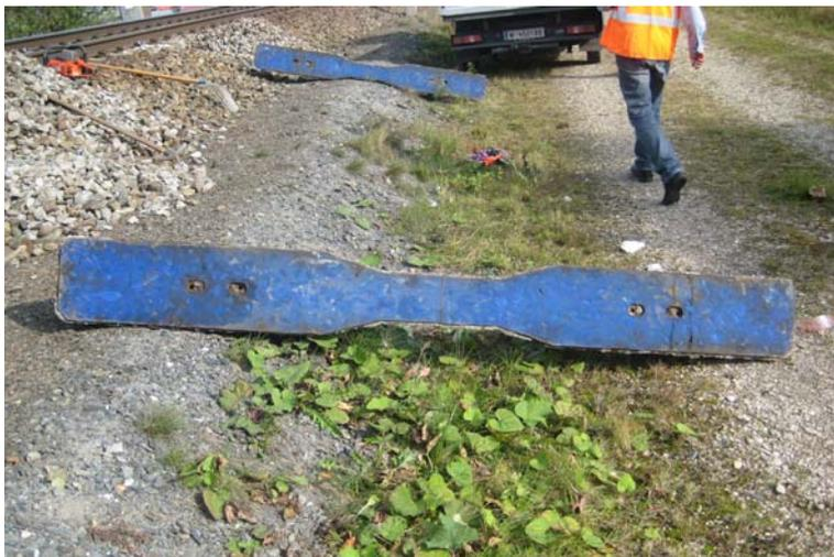
Abb. 1.60: Die Abbildung zeigt zwei Schwellen mit Schwellenbesohlung (SLS 1308 G) 7 Jahre nach der Gleisneulage bei einer kumulierten Belastung von ca. 150 Mio. Gesamtbruttotonnen. Die Verschleißerscheinungen sind gering, eine Nutzungsdauer der Besohlung von 40 Jahren scheint auch bei weichen Besohlungsmaterialien und hohen Verkehrsbelastungen realistisch.
