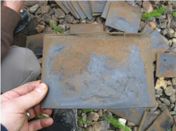
Abb. 1.19: In engen Gleisbögen werden die Zwischenlagen bei Verwendung der Spannklemmen Skl 12 nur einseitig beansprucht (Schienenkippen). Das Material zeigt hier Merkmale einer Überbeanspruchung durch übermäßiges Durchwalken.
