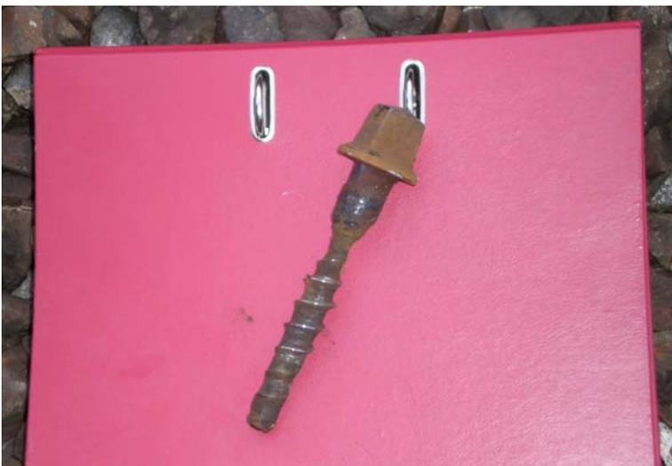
Abb. 1.21: Dieses Bild zeigt eine Schwellenschraube mit fortgeschrittenen Korrosionserscheinungen. Eine Wartung entsprechend den Vorgaben der ZOV 32 (Eintauchen in Gewindebitumen als Vorarbeit vor Stopfarbeiten) hat hier nicht stattgefunden. Da dieser Zustand in Bögen zum Versagen des Systems führen kann, ist es wichtig bei der Inspektion auch Schrauben vereinzelt herauszuziehen und bezüglich des Schädigungsgrads zu beurteilen. (Foto: BM Ernst Röck)
