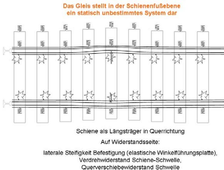
Abb. 2.26: Der Gleisrost ist in Querrichtung als statisch unbestimmtes System anzusehen. (s.a. Anhang 1)
