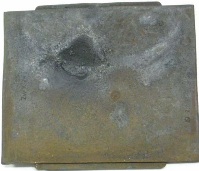
Abb. 1.75: Die EVA-EPDM-Verbundstoff-Zwischenlagen zeigen in Bögen nach wenigen Jahren Zeichen einer deutlichen Überbeanspruchung.
