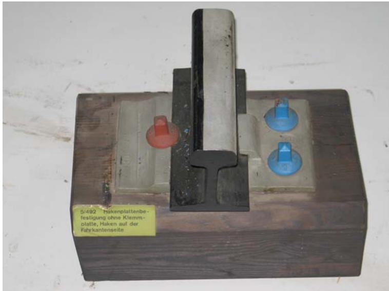
Abb. 1.11: Hakenplattenbefestigung ohne Klemmplatte, Haken auf der Fahrkantenseite
