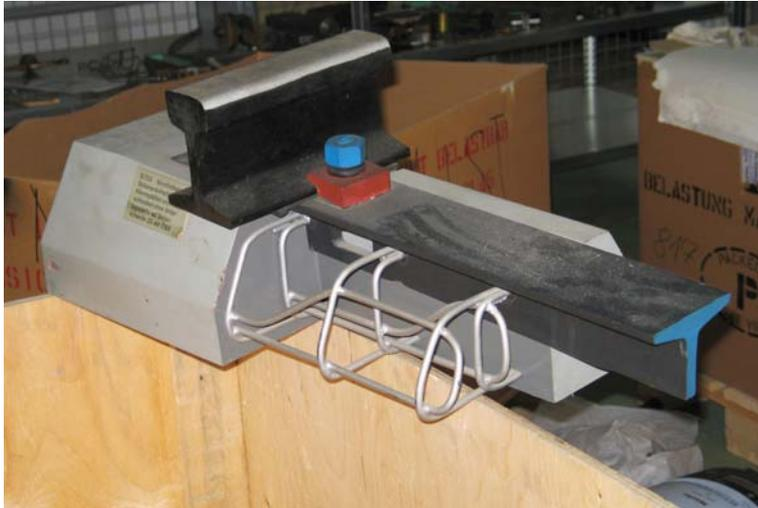
Konstruktion kann in Bögen die Langlebigkeit der Rippenplattenkonstruktion nicht erreichen und wurde nur in schwächer belasteten Bahnhofsgleisen verwendet.
