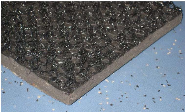
Die in Gleisen der ÖBB bislang am meisten verwendeten Schwellenbesohlungen haben als Kontaktmedium ein Kunststoffgeflecht (Wirrgitter). Dieses wird im Produktionsprozess in das Besohlungsmaterial eingebunden. Bei der Schwellenproduktion wird das Besohlungsmaterial mit dem Wirrgitter in den Beton eingerüttelt, der Verbund erfolgt über das Wirrgitter (Abb. 1.53).
