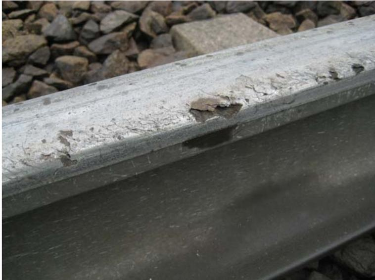
(Abb. 1.104). Sie entstehen aufgrund einer hohen Längsbeanspruchung des Rad-Schiene-Berührungspunktes. Es sind vor allem Gleise mit Richtungsbetrieb betroffen, eingleisige Strecken (ohne große Längsneigungen) zeigen dieses Phänomen nicht. Head Checks können im Endstadium zu sog. „Trümmerbrüchen“ (z.B. Hatfield im Jahr 1999) führen.
