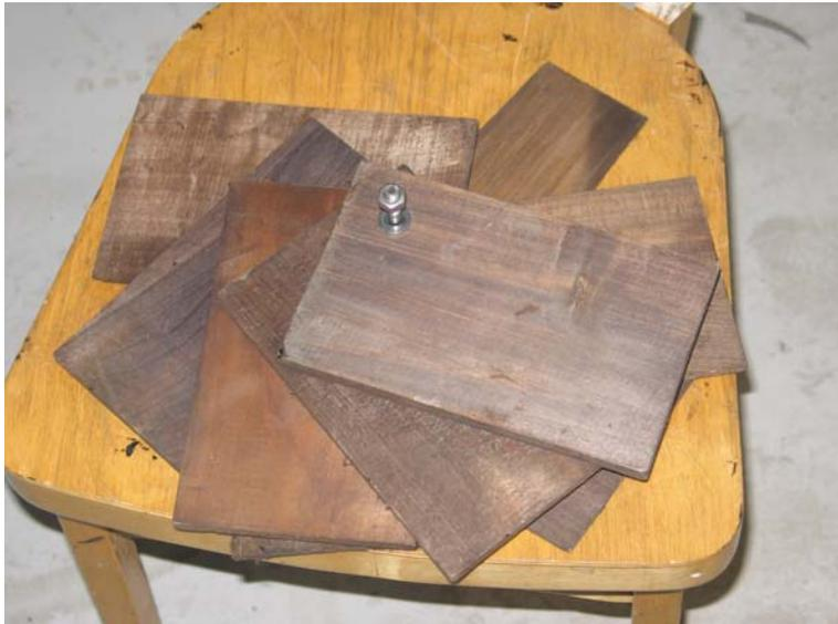
Abb. 1.70: In den 1950er und 1960er Jahren wurden bei Betonschwellengleisen Zwischenlagen aus gepresstem Pappelholz verwendet. Die Elastizität hat sich aufgrund von Verdichtungsvorgängen im Holzfaserverband jedoch relativ rasch verkleinert. (Foto: TMW)
