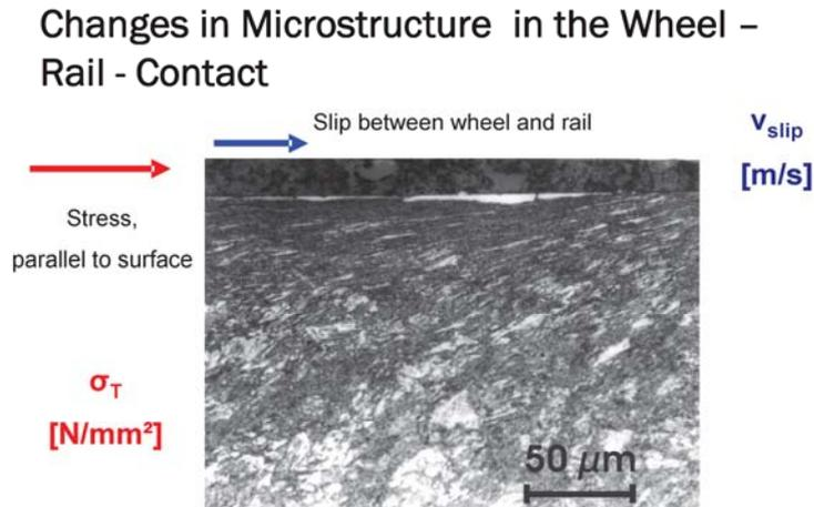
Abb. 2.86: Pointner führt Verschleißvorgänge im Rad-Schiene-Kontakt auf das Zusammenspiel Kontaktspannung  $\sigma_T$  und Relativgeschwindigkeit  $v_{slip}$  zurück. [48]
