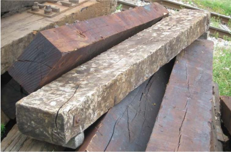
Abb. 1.54: Ein Grund für die lange Einsatzdauer von Holzschwellen ist die Eigenelastizität des Naturstoffs Holz. Zwischen Schotterbett und Schwelle besteht eine große Kontaktfläche, der Schotter wird geschont.
