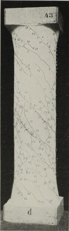
Abb. 2. Auf Torsion beanspruchter, mit Spiralen bewehrter Betonzylinder
