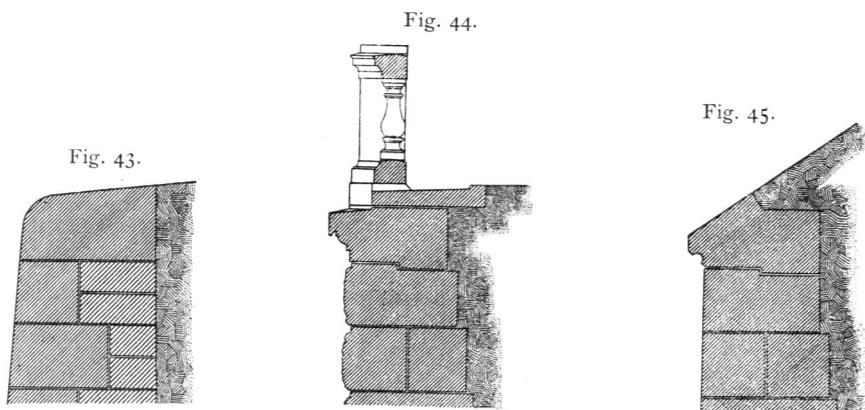
springendes Gefims nothwendig, dessen Traufkante bei lothrechter Mauerflucht diese vor dem Regen etwas schützt. Dieser Schutz entfällt bei geböfchten Mauern. Eine Ueberfaltung mit der nächstunteren Schicht erscheint zweckmäfsig, um Verschiebungen zu verhindern (Fig. 44). Diese letztere Mafsregel ist noch wünschenswerther, wenn der Boden über der Mauer ansteigt (Fig. 45). Auf diesen Umstand ist auch in der Bildung des oberen Lagers Rückficht zu nehmen.
