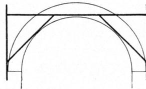
Der Anker ist aus hochkantig gelegtem Flacheisen, welches in die Unterseite des Bogens genau eingelassen ist, herzustellen und hinter den Widerlagsteinen mit Splinten zu versehen.
