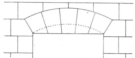
durch noch von der Ueberdeckung durch Auskragung, daß ein Schlufsstein vorhanden ist. Diesen ganz wegzulassen und nur zwei ausgekragte, nach der Bogenlinie ausgearbeitete Stücke an einander zu schieben (Fig. 858) ist nicht empfehlenswerth.
