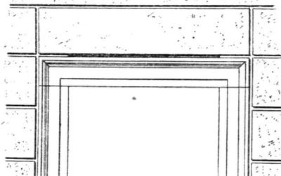
Ist dies nicht der Fall, so muß man zur Entlastung Auskragungen, Spannschichten, Bogen oder Eifenträger über dem Steinbalken anwenden.
