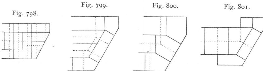
1) er wird einfach schräg abgeschnitten, wobei sich ein spitzwinkliger Auslauf der Zwischenfugen ergibt (Fig. 798), der nur bei Putzüberzug zulässig ist;
