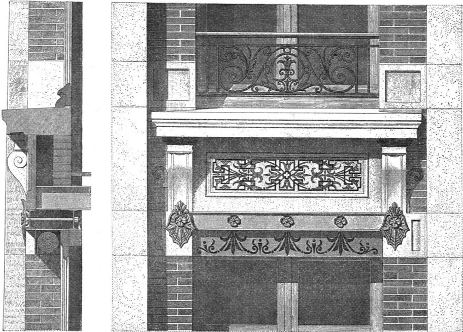
Ein Beispiel hierfür bei gewöhnlicher Fensterweite bietet Fig. 927<sup>880</sup>). Das Auflager der Träger ist durch aufgelegte Gufsverzierungen verdeckt. Das Beispiel zeigt zugleich, wie in solchen Fällen äussere Rollläden angebracht werden können.
