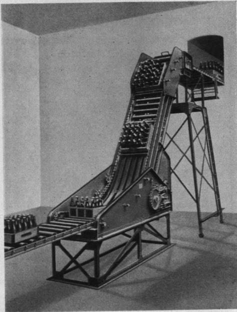
Abb. 252. Rollbahnen in einem Flaschenversandlager; zur Überwindung eines Höhenunterschiedes ist ein Steilförderer eingeschaltet, der durch zwei außenliegende Ketten und zwischen diese gespannte Mitnehmer die Flaschenkästen teils über glatte Rutschflächen, teils über geneigte Rollbahnen hochschleppt.
