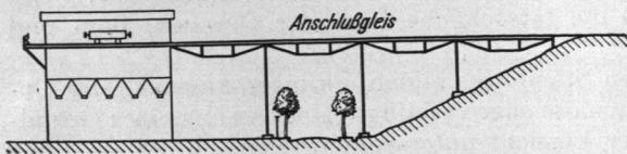
Abb. 3. Ausnutzung von Höhenunterschieden für Transportzwecke.
