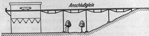
Abb. 3. Ausnutzung von Höhenunterschieden für Transportzwecke.
