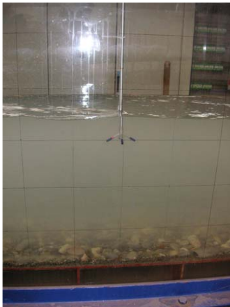
Abbildung 9: Glasgerinne mit Geschwindigkeitsmessgerät Vectrino+
