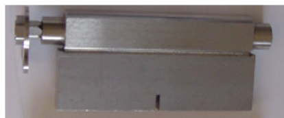
Anker 3: massiver Anker mit Stößel für E-Magnetform
