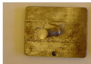
Anker 3: massiver Anker mit Stößel für E-Magnetform
