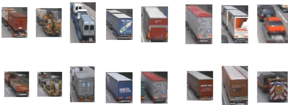
Abbildung 67: Typische Beispiele für false positives, die nicht durch die Verifikation entdeckt wurden (echte false positives). Man erkennt gut, dass hier die auch die globalen Moden für die Verifikation ähnlich aussehen werden.
