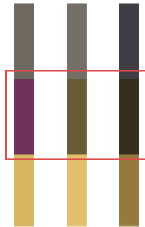
Abbildung 25: Das mittlere Feature wird gegen das linke und rechte Feature gematcht. Während beide Features dieselbe Gesamtdistanz zum mittleren Feature haben, matcht das linke Feature aufgrund der zu großen Einzeldistanz (vgl. mittleren Mode) nicht .
