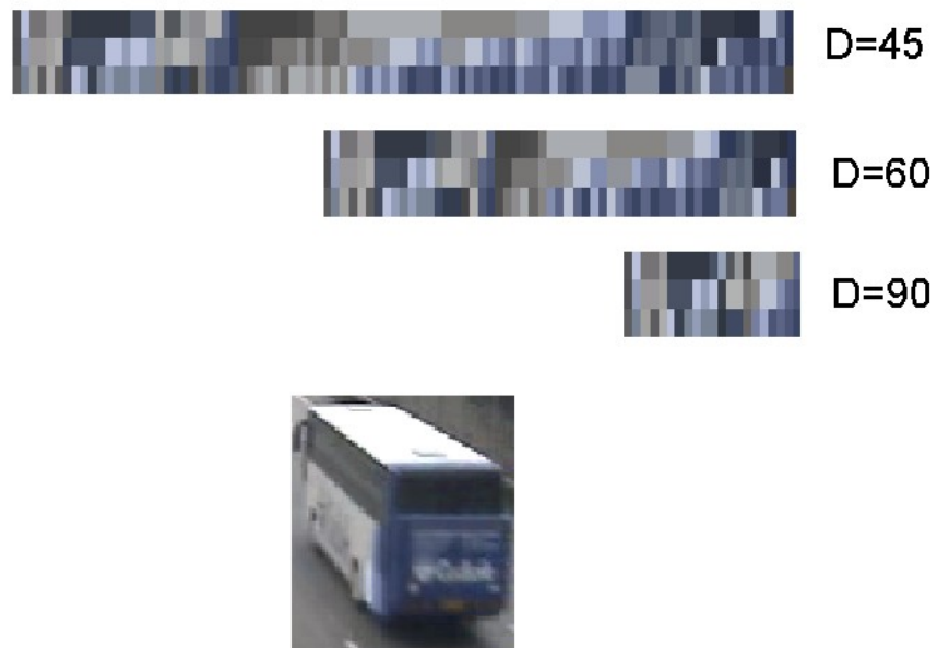
Abbildung 51: Die Mode-Kombinationen mit unterschiedlichen Pruning Abständen. Man erkennt, dass auch mit sehr starker Pruning ( D=90 ) die wesentlichen Farbübergänge weiß-blau-grau repräsentiert sind. „Reines“ Weiß (z.B. am Fahrzeugdach) kommt nicht vor, da zu helle Farben vom Algorithmus geclipped werden.
