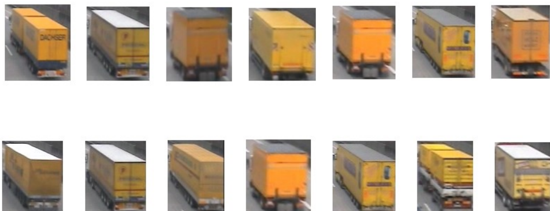
Abbildung 27: Die Fahrzeuge aus dem Set 2 haben zum Teil sehr ähnliche Features (hier z.B. rot-gelb Übergänge). Außerdem sind oft nur wenige starke Features vorhanden (aufgrund schwacher Texturierung ergeben sich wenige markante Farbübergänge.)
