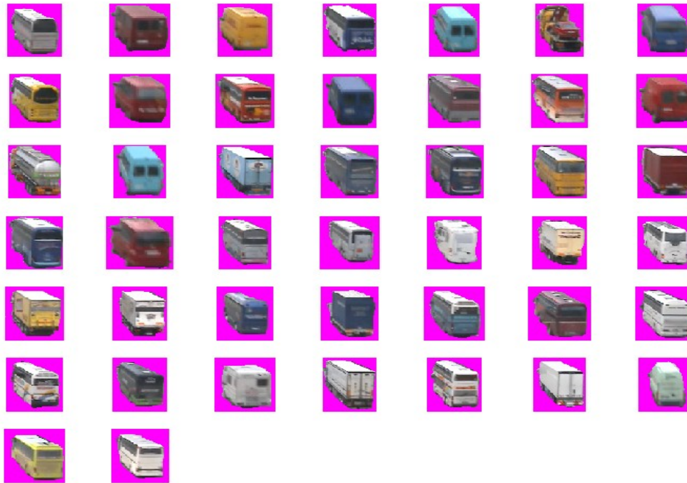
Abbildung 29: Beispielbilder aus dem Set1. Die Maskenfarbe ist mit [255,0,255] gewählt, eine Farbe, die -aufgrund des Sättigungsgrades- in den Aufnahmen nicht vorkommt. Man sieht, dass im Set sowohl deutlich texturierte Fahrzeuge, als auch solche mit eher homogenen Farbverläufen bzw. ohne deutliche Farbstruktur enthalten sind.
