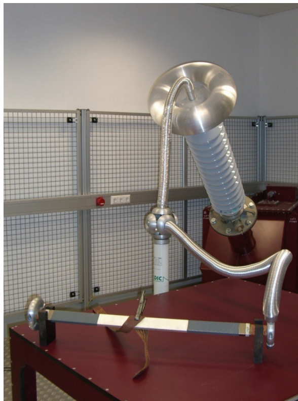
Abb. 41 Teilentladungsmessung im Labor mit Prüftrafo, Koppelkondensator und Generatorstab als Prüfling
