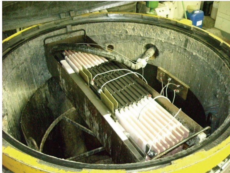
Abb. 27 Offener Imprägnierkessel mit in der Nutimitation eingeschweißten Generatorstäben
