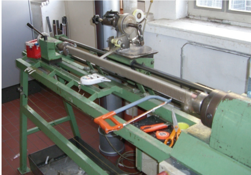
Abb. 29 Verwendete Wickelmaschine beim Aufbringen der Hauptisolation
