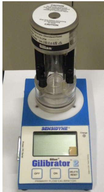
Abbildung A-1: Volumenstrommessgerät Gilibrator 2
