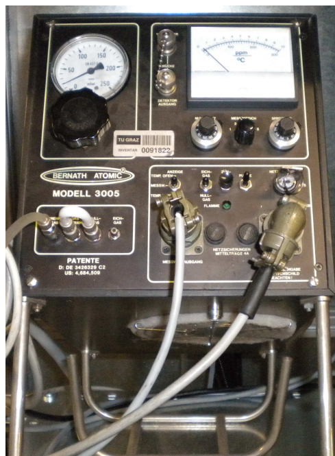
Abbildung A-2: Flammenionisationsdetektor (FID)
