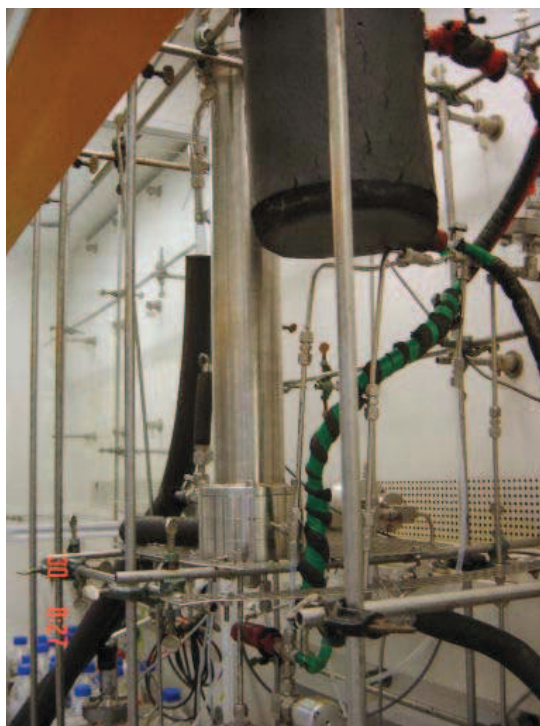
Abbildung 33: Anlage mit Rohrreaktor; Fallrohr_600 (links) und Fallrohr_200 (rechts)
