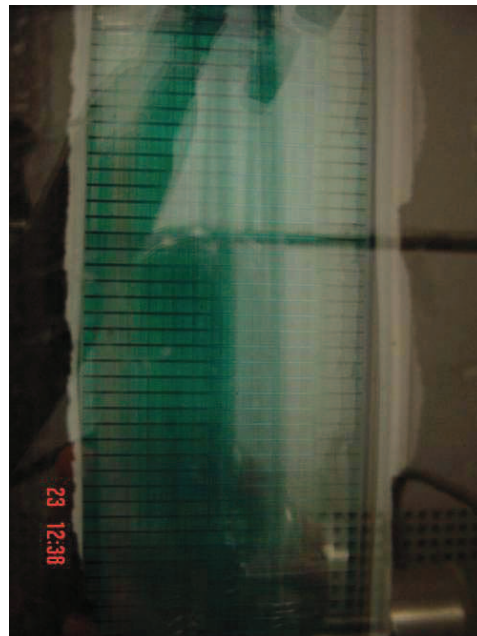
Abbildung 31: Fotos vom Fließverhalten (Fallfilm-Mikroreaktor); Fischgräten-Muster (links) und Querrillen-Muster (rechts)
