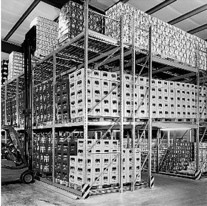
**Abbildung 1.14 (a):** Durchlaufregallager eines Getränkeherstellers (vgl. TEN HOMPEL UND SCHMIDT UND NAGEL [Lit. 9], 2007). Foto: Bito
