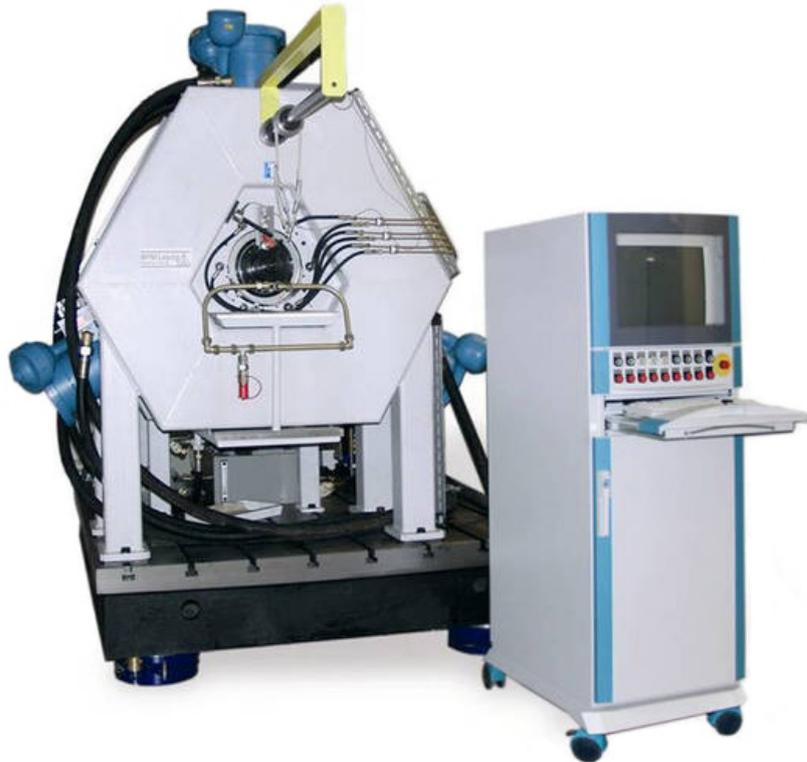
**Bild 3.6** Gleitlagerprüfstand WPM Werkstoffprüfsysteme Leipzig [16]
