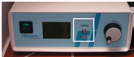
Abbildung 4.41: Öffnen und Schließen der Glasventilstempel mittels Kippschalter
