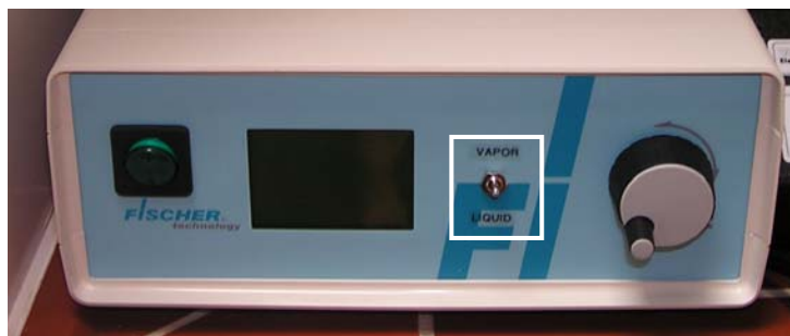
Abbildung 4.46: Öffnen und Schließen der Glasventilstempel mittels Kippschalter
