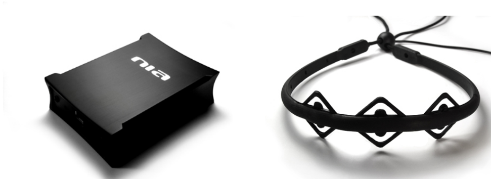
Abbildung 4.4: Die Hardwarekomponenten des NIAs: Interfacebox (links); Kopfband mit drei Elektroden (rechts)
