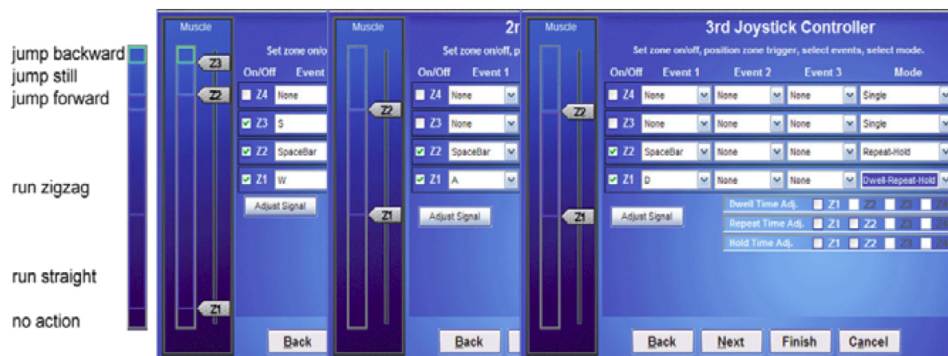
Abbildung 5.7: Parallel-Joysticks zur Simulation gleichzeitiger Aktionen (z. B. mehrfache Tastenanschläge) [OCZ 2008, S. 23]
