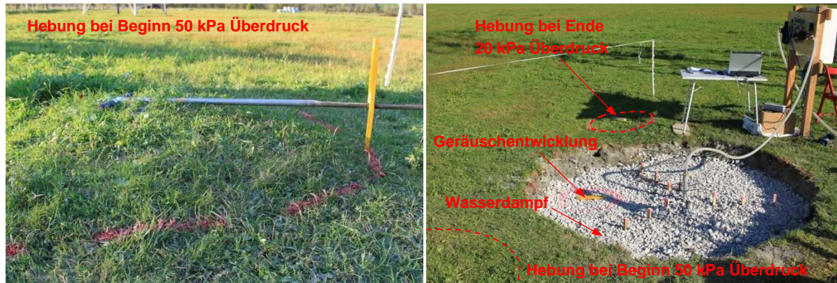
Abb. 3-25: Hebungen beim Feldversuch 3
