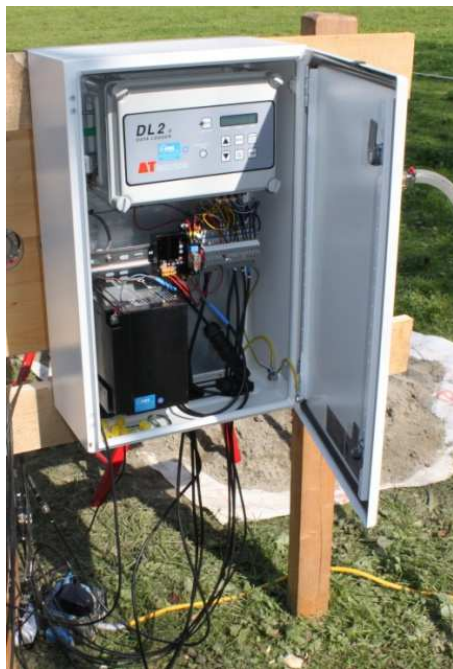
Abb. 3-14: Messschrank mit DL2e Datenlogger im Feld
