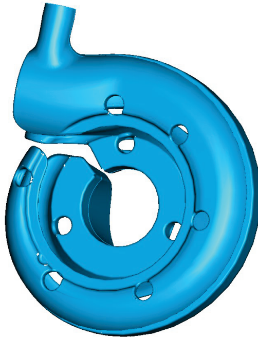
Abb. 2.29 Basiskonzept Kühlmantel Turbinengehäuse AVL „Verdichterseite“
