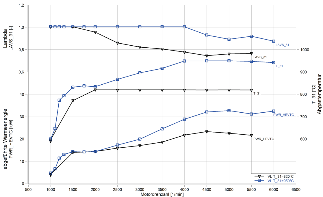
Abb. 4.9 Vergleich der abgeführten Wärmeenergie im VTG für Vollastkurven mit unterschiedlichen Abgastemperaturen (bzw. \lambda ), Variante 2
