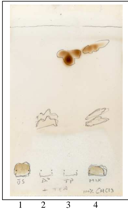
Abb. 2-3: DC zur Bestimmung der R F -Werte von Ölsäure (lane 1), Dipalmitin (lane 2) und Tripalmitin (lane 3). Auf lane 4 wurde das Referenzgemisch mit allen drei Substanzen aufgetragen. Auf alle Startpunkte wurde vor Beginn der Trennung ein Tropfen TEA (Triethylamin) aufgetragen, Laufmittel war reines CHCl 3 . Die Spots wurden mit I 2 -Dampf sichtbar gemacht und danach mit Bleistift dauerhaft markiert.
