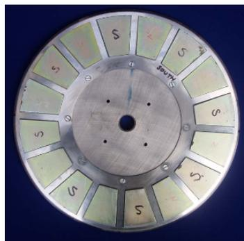
Abbildung 18: Rotor mit Permanentmagneten einer Axialflussmaschine mit Luftspaltwicklung
