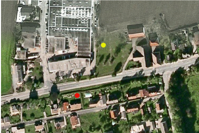
Abbildung 4-58 Messaufbau in Klagenfurt Viktring für den Messzeitraum 14.03.2008 bis 03.04.2008 (rot: straßennahe Messstation, gelb: Hintergrund Messstation) [EU Life Umwelt, 2007].
