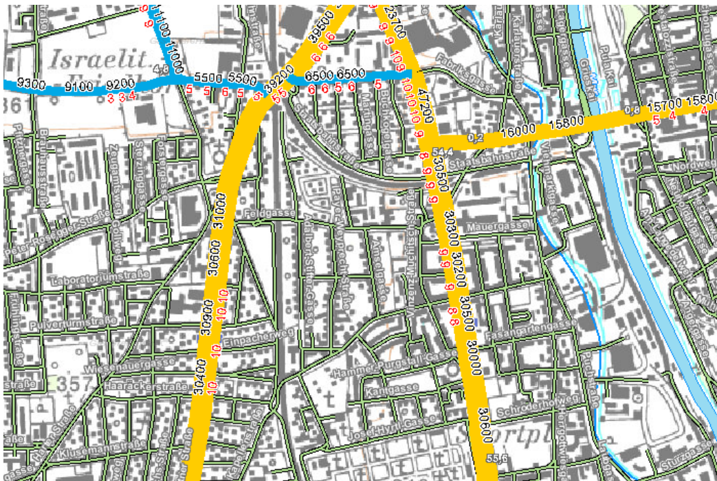
Abbildung 4-4 Der Schwerverkehrsanteil auf der Kärntnerstraße beläuft sich lt. GIS Steiermark auf 10 % (rote Zahl) [GIS Steiermark, 2013].
