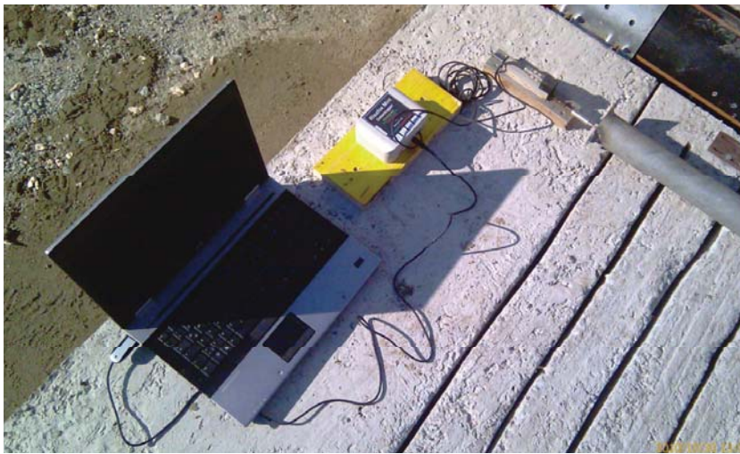
Abbildung 59. Ziehharmonikaplatte ohne Asphalt mit Messeinrichtung
