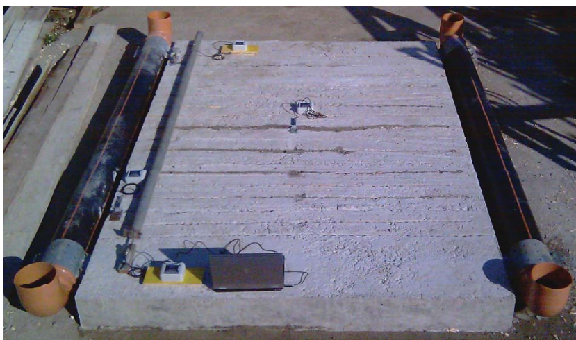
Abbildung 60. Gesamtüberblick des Verformungsversuches Ziehharmonikaplatte ohne Asphalt
