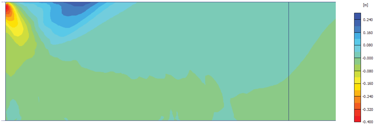
Abbildung 32. Setzungen und Hebungen im Bereich der Hinterfüllung - maximale Hebung ca. im Abstand H/2 von der Widerlagerwand
