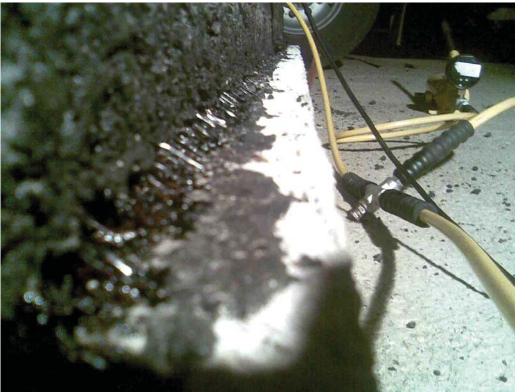
Abbildung 78 Schlupf am Anfang (Festhaltepunkt) der Platte ~20mm
