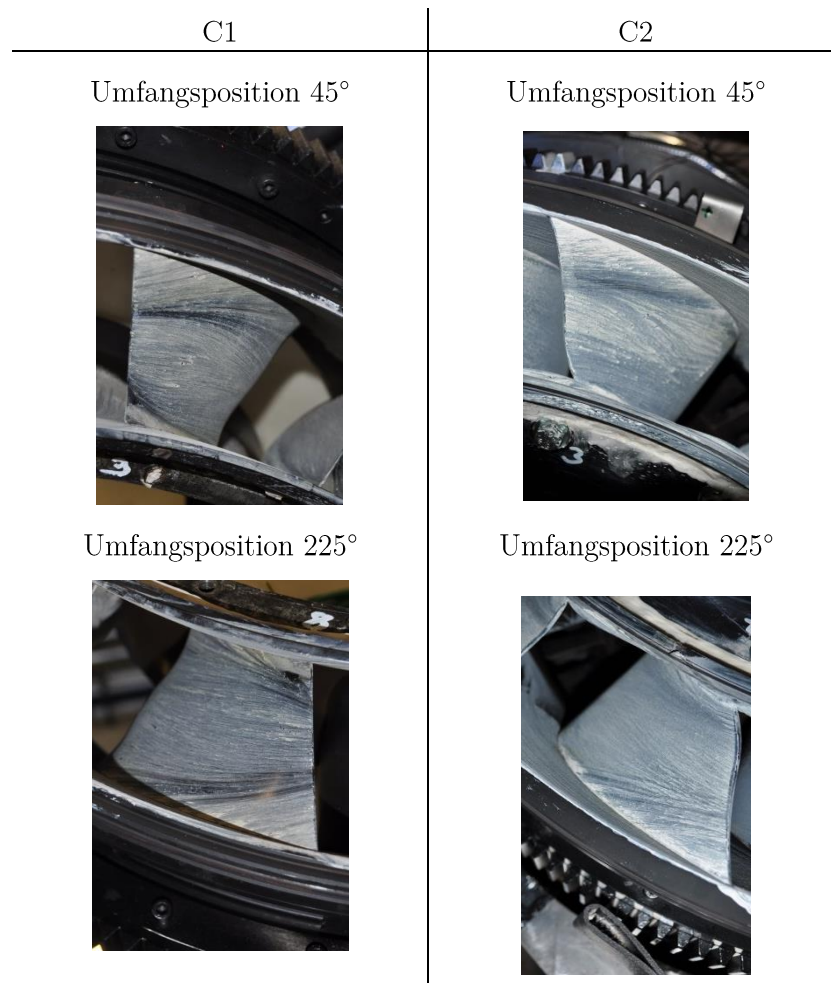
Abbildung 4.9: Ölanstrich auf den Schaufeloberflächen (Saugseite) der beiden TMTF-Konfigurationen an verschiedenen Umfangspositionen
