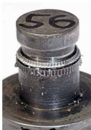
Abbildung 61: Fließspanbildung, ein zusammenhängender Span.
