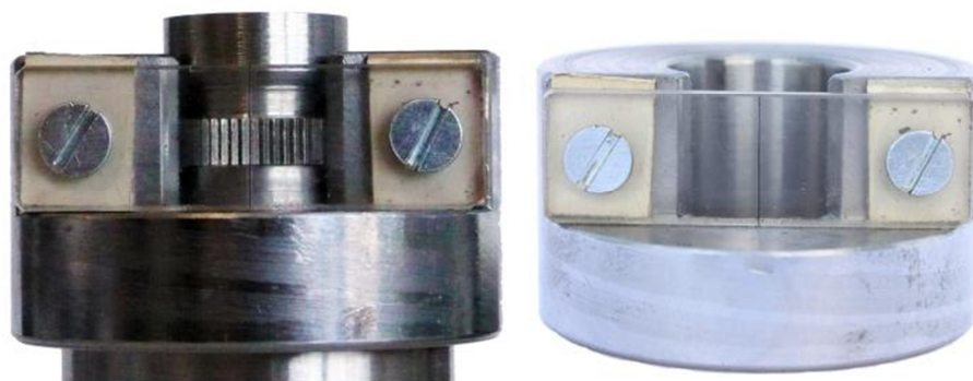
Abbildung 23: Selbst gebaute Lehre zur Kontrolle der Achsparallelität
