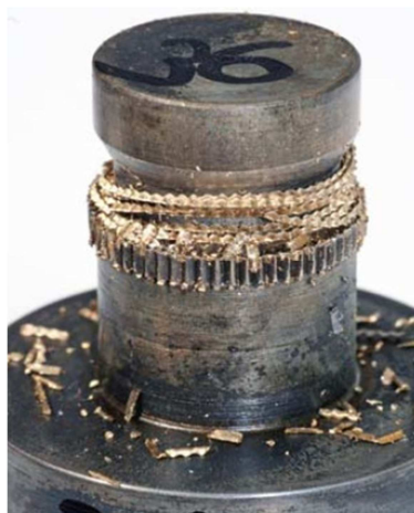
Abbildung 59: Kurzspanbildung von Messing 37
