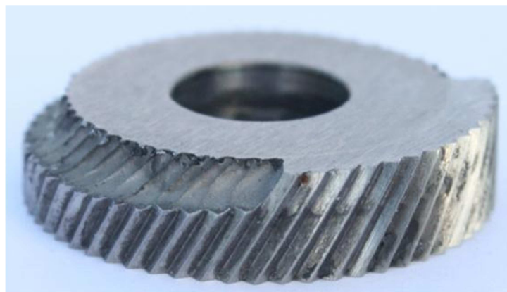
Abbildung 27: Ausbrechen von Zähnen des Rändelfräasers
