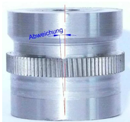
Abbildung 21: Rändelverzahnung nicht achsparallel
