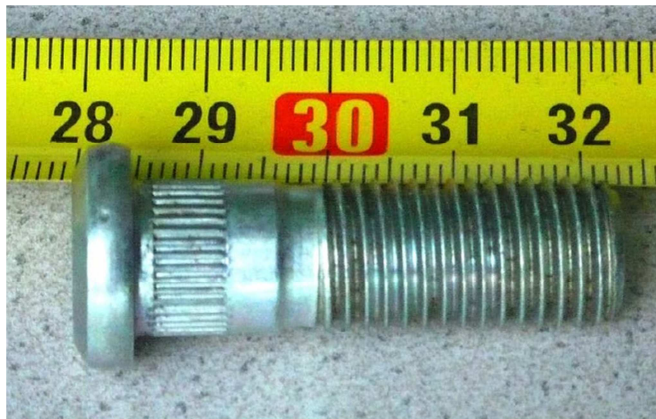
Abbildung 3: Toleranzausgleich und Verdrehsicherung mittels Rändelung einer Radflanschschaube
