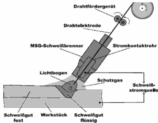
Abbildung 11: MSG (Metallschutzgas) – Schweißprozess [13]
