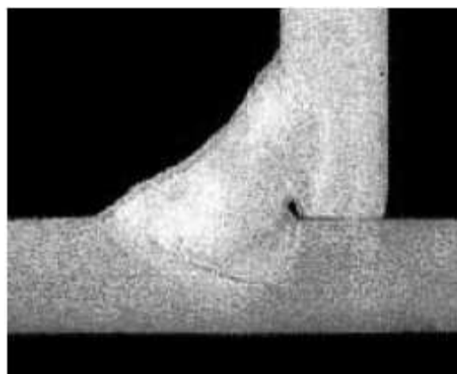
Abbildung 44: Wurzelkerbe durch Oxide [38]
