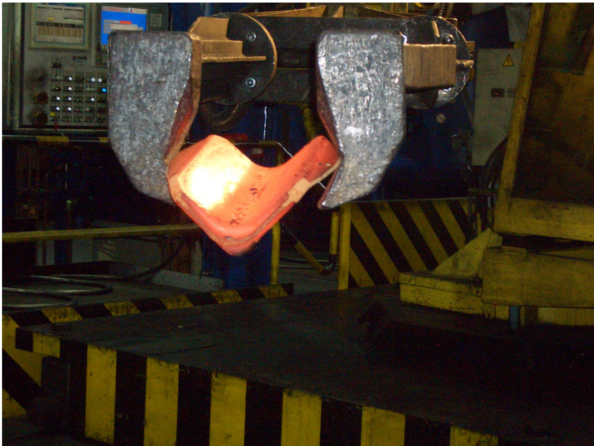
Abbildung 79: Geschmiedetes Fertigteil direkt nach der Umformung
