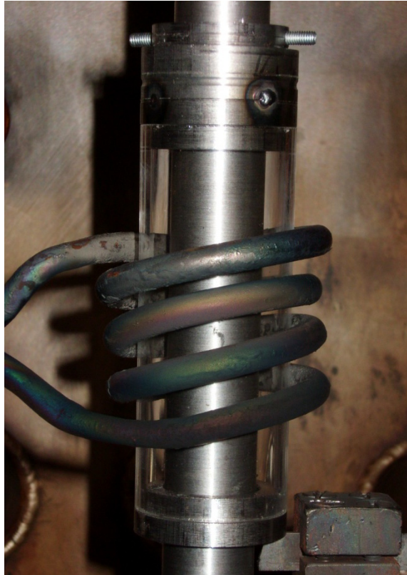
Abbildung 34: Vorrichtung zur Umspülung der Probe mit Schutzgas
