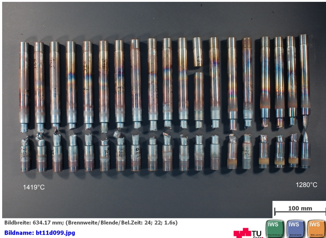
Abbildung 48: Makroskopische Aufnahme der gezogenen Proben
