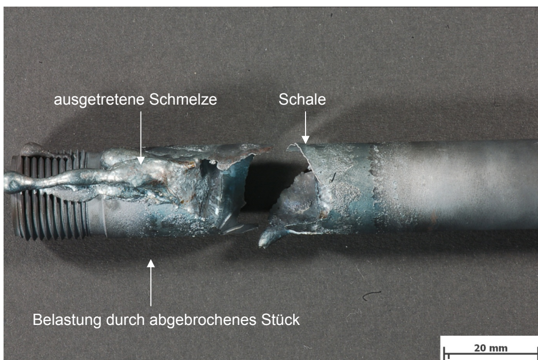
Abbildung 36: Ausgetretene Schmelze einer niedriglegierten Stahlprobe, die nur durch das Eigengewicht belastet wurde
