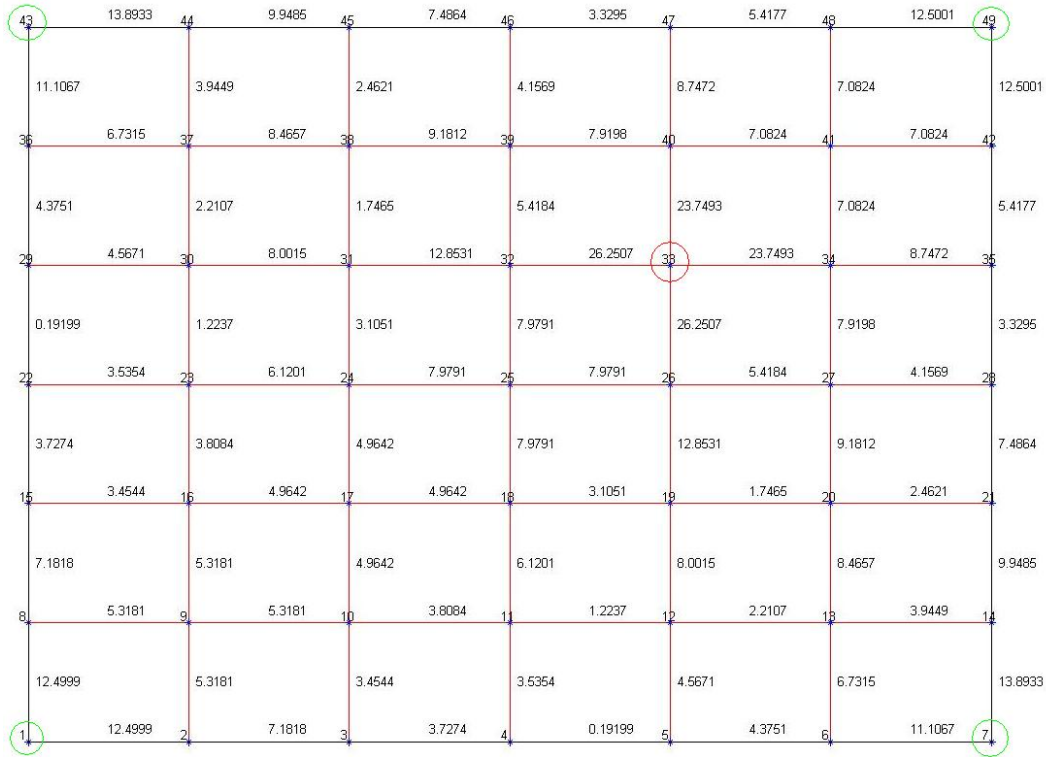
Abbildung 6.3: Darstellung eines 7*7 Netzwerkes mit Stromspeisung in Knoten 33 und Erdungspunkten in den Knoten 1,7,43 und 49
