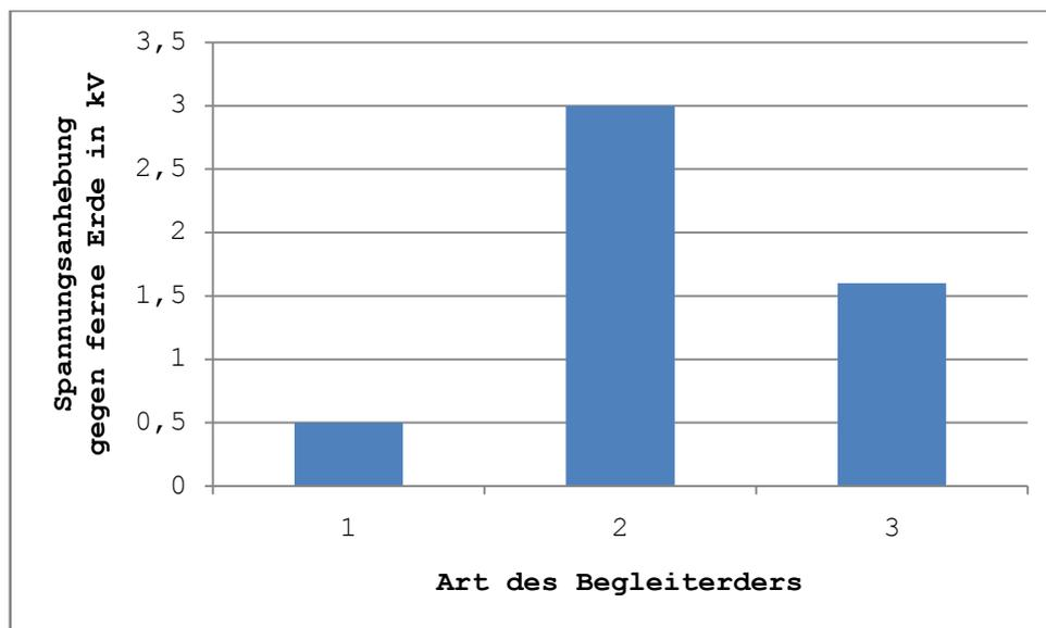
Abbildung 15: Spannungsanhebung des Umspannwerks bei einem Erdseileinschlag von 50 kA (1.2/50  $\mu$ s, Heidler-Typ) in den letzten Freileitungsmast ohne (1), mit erdfühligem (2) und mit isoliertem Begleiterder (3)
