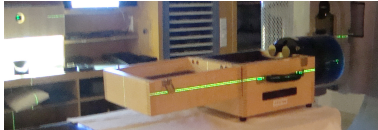
Abbildung 1: Positionierung des CatPhan-Phantoms mit Hilfe der Raumlasern. Zur Positionierung des Phantoms wurden die verschiedenen Marker (lateral height dots und center dots) des CatPhan-Phantoms verwendet (siehe Abb. 12).
