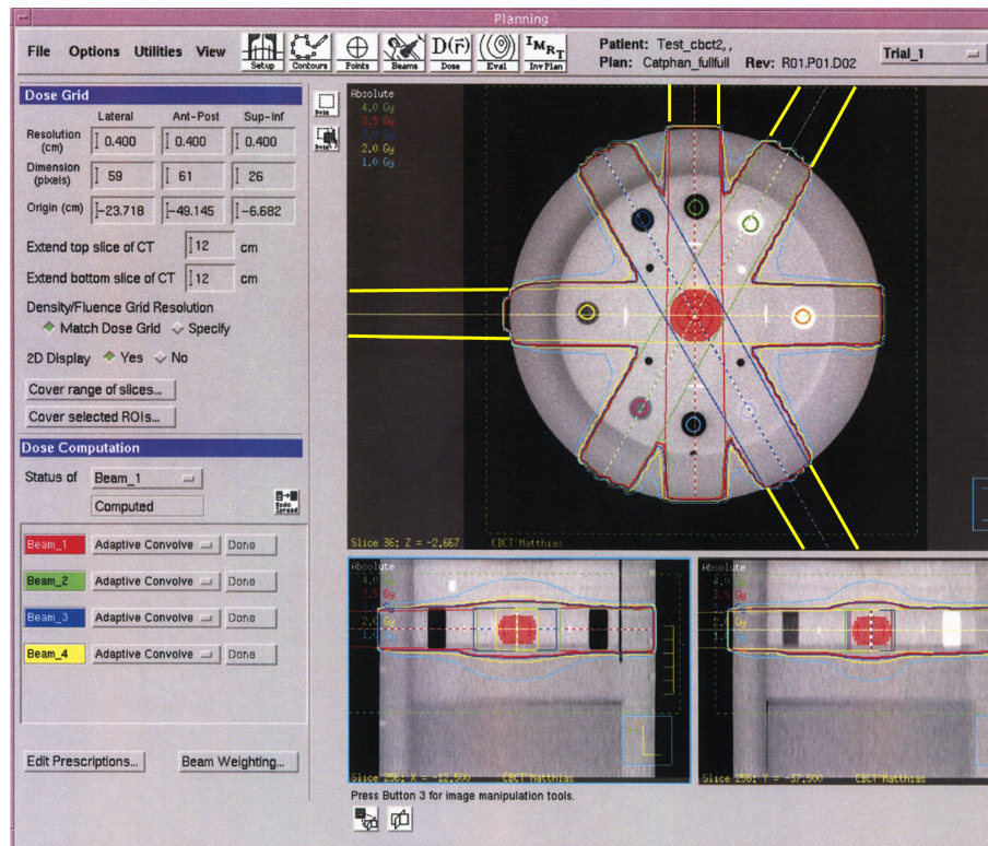
Abbildung 27: Bestrahlungsplan des CatPhan-Phantoms. Die Abbildung zeigt das Planungssystem mit den berechneten Dosisverteilungen im CatPhan-Phantom. Gelbe Linien außen zeigen die Feldgrenzen.
