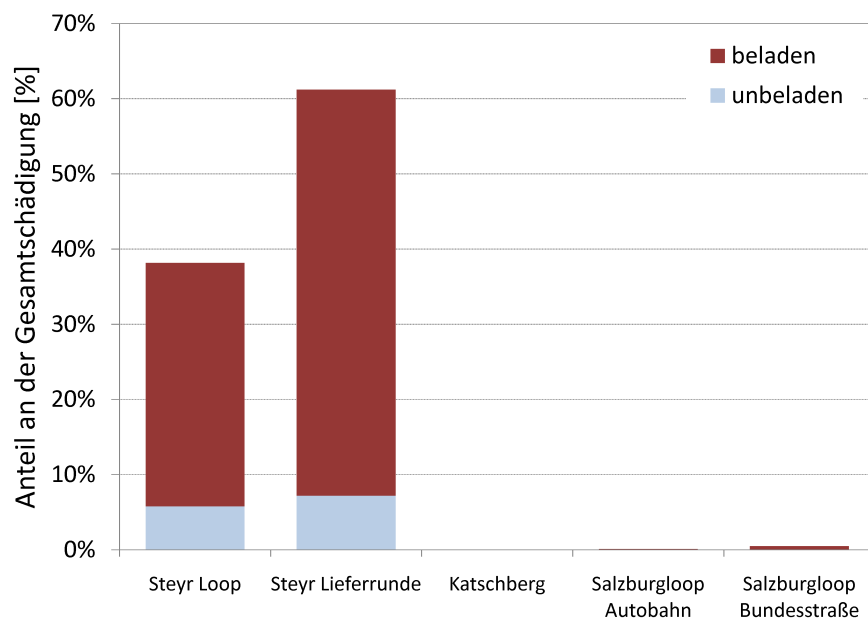
Abbildung 6.21: Schädigungsanteile im 2. Gang in Abhängigkeit vom Beladungszustand (negative Momente)
