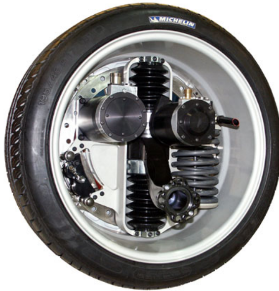
Abbildung 2.5: Radnabenantrieb (Michelin Active Wheel)[1]
